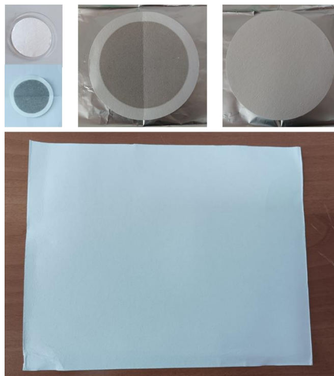
Figura 3.10. Tipos de filtros de fibra de cuarzo utilizados en los distintos captadores de PM10.
