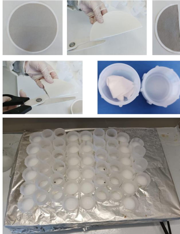
Figura 3.15. Corte y tratamiento se los filtros muestreados para la digestión ácida.
