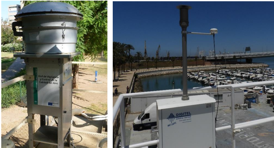
Figura 3.9. Captador de alto volumen TISCH (izquierda) y captador de bajo volumen DIGITEL DPA14 (derecha).
