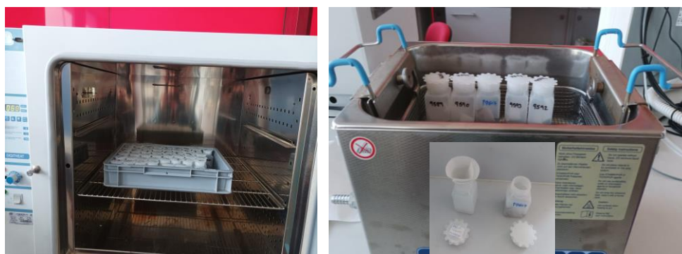
Figura 3.16. Proceso de lixiviación acuosa de los filtros muestreados para la determinación de iones.
