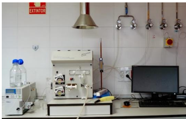
Figura 3.18. Acoplamiento instrumental HPLC-HG-AFS para la especiación de As.
