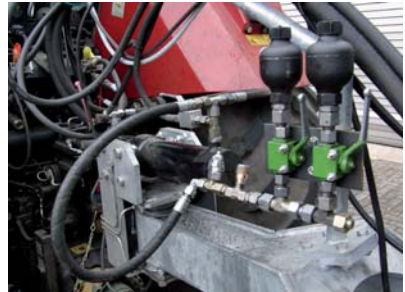
Abb. 6.11: Straßenfahrt-Versuche: Hydraulische Realisierung des Topzylinders als adaptives System
