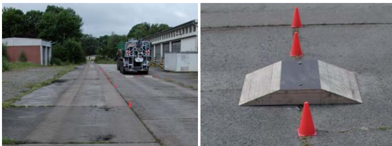
Abb. 5.2: Straßenfahrt-Versuche: Linke Seite: Betonplattenweg (links) und Einzelhindernis (rechts) ; Rechte Seite: Großaufnahme Einzelhindernis
