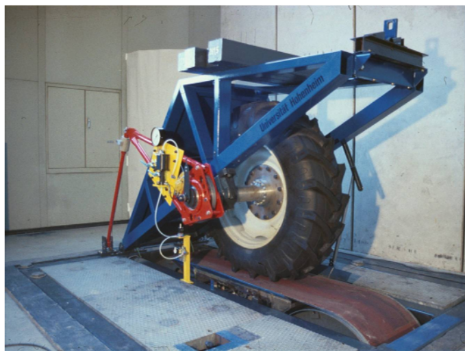
Bild 10: Flachbandprüfstand mit Bremseinrichtung [29]
