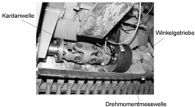
Bild 22: Drehmomentmesswelle im Antriebsstrang der Pickup
