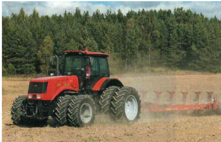
Bild 14: Ackerschlepper Belarus 3023 mit diesel-elektrischem Antrieb [102]
