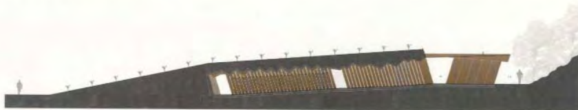
Sección transversal por cave de botellas / Cross section through bottle storage
