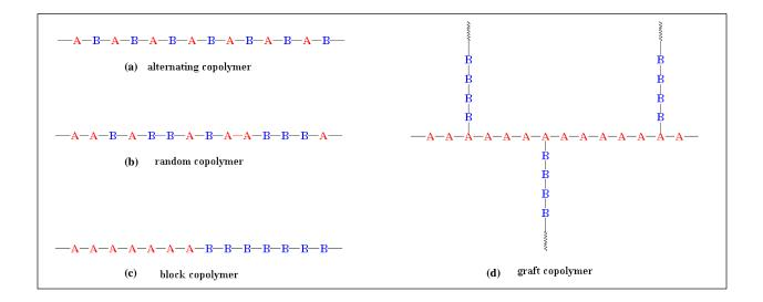
**FIGURE 1.2.2:** (a) alternating copolymer, (b) random copolymer, (c) block copolymer, and (d) graft copolymer.
