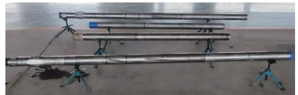
图5 \phi 133 mm 液驱推靠式旋转导向钻进系统
