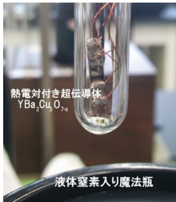
写真 8. 超伝導体測定装置 (超伝導体部分)
