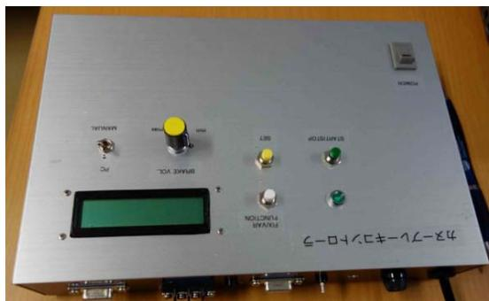
図3 コントロールボックス 負荷装置とは3メートルのケーブルで接続し、ブレーキへの電流調節によって負荷を調節する。負荷装置側からのエンコーダー出力を用いて、ストローク毎の負荷制御を行うことが可能である。また、USBまたはRS-232C経由でPCと接続し、負荷制御、負荷変化、仕事量などをPC上から計測制御可能である。
