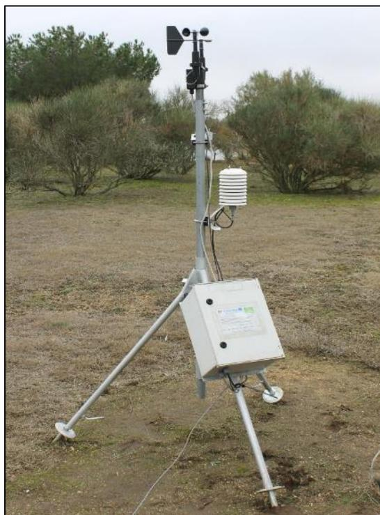
Figura 71 - Estación meteorológica.
