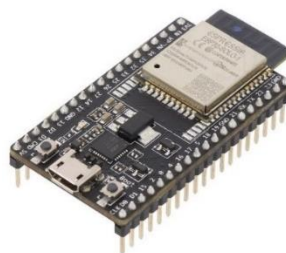
Figura 15 – ESP-32 Dev kit V2
