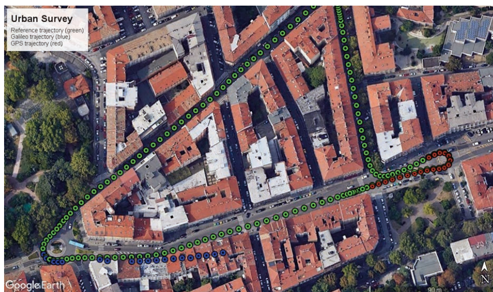
Figura 1 – Tracciati Galileo (in blu), GPS (in rosso) confrontati con la traiettoria di riferimento MMS (in verde)
