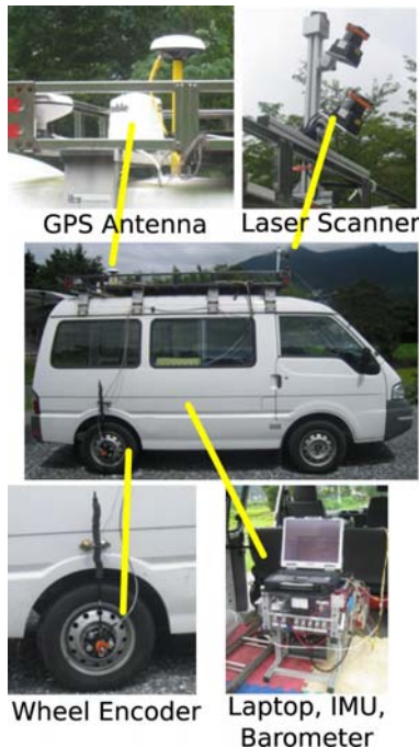
図 6 計測装置の車上配置
