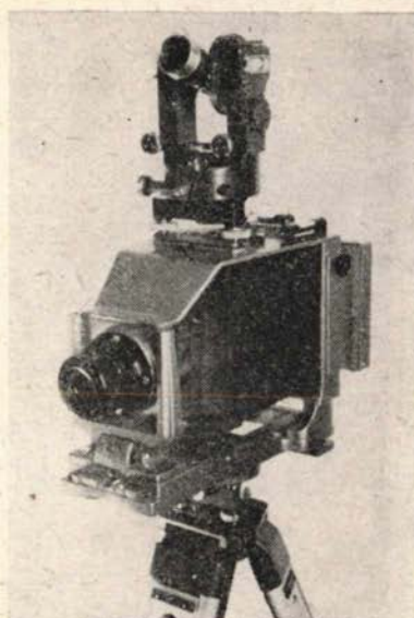
Sl. 8 — Fotokamera 1318/360 s teodolitom
