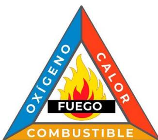
Figura 9: Triángulo del fuego [24]
