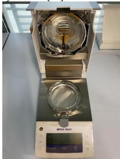
Figura 38: Analizador de humedad HE53 de Mettler Toledo Greifensee, Suiza
