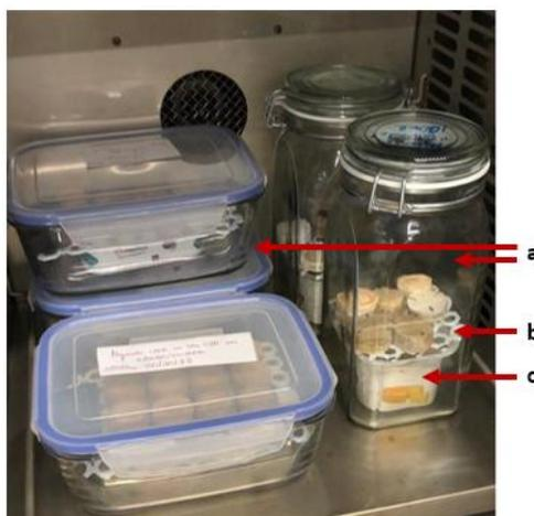
Figura 40: estabilización con a) recipientes compuestos de b) una rejilla y c) una solución de ácido sulfúrico
