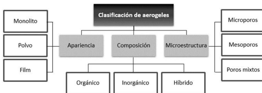
Figura 1: Clasificación de aerogels según la apariencia, la composición y la microestructura
