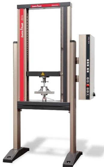
Figura 43: Máquina universal de ensayos (ZwickRoell Z010, 10 kN RetroLine) para el ensayo de compresión [69]
