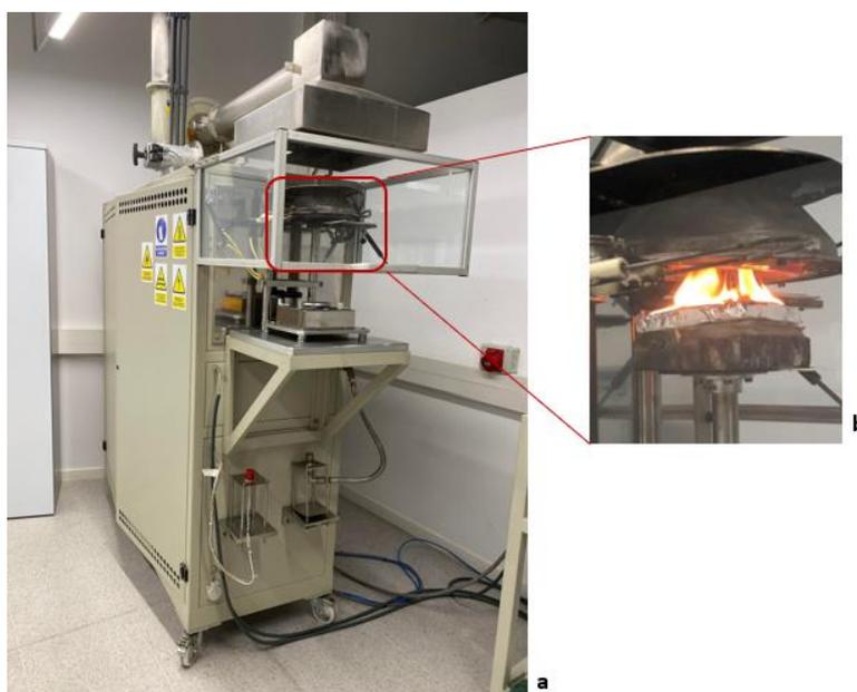
Figura 45: a) Cono calorímetro BECC de Ineltec, Tona, España y b) producción de llamas durante la prueba
