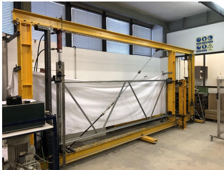
Figura 2 – Marc de càrregues en el moment d'un assaig
