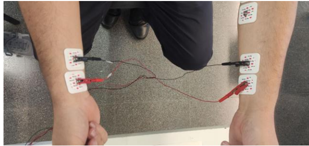
Il·lustració 21: Distribució dels elèctrodes en els dos braços per detectar la respiració
