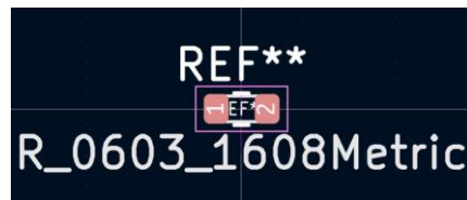
Il·lustració 12: empremta de la referència 0603_1608
