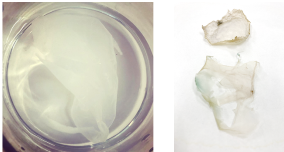
(a) acabada de netejar amb NaOH 1 % a 70°C overnight amb agitació (700rpm); (b) un cop seca.
