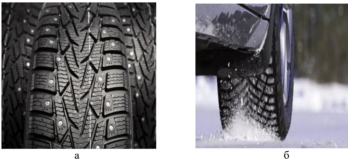
Рис. 2. Зимние шипованные шины (а), фракционированные шины (б)
