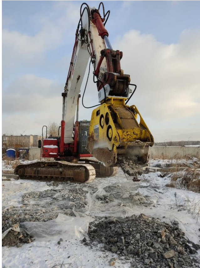
Получение вторичного щебня с помощью дробильного ковша
