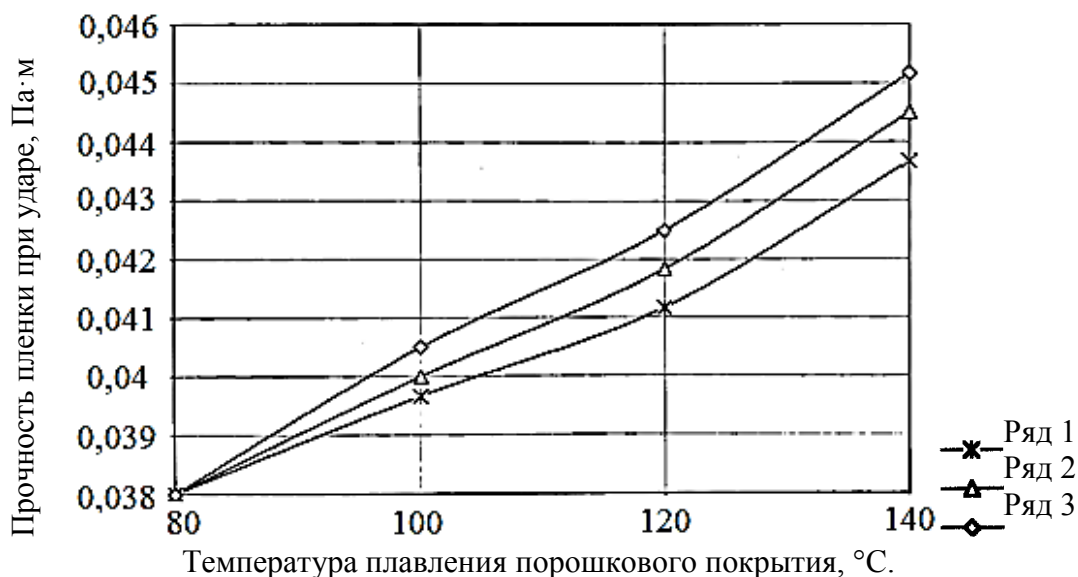
Рис. 1. Зависимость прочности при ударе для эпоксидно-полиэфирного порошкового покрытия при различном времени отверждения.
