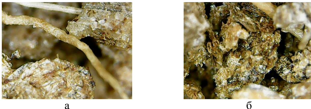
Рис. 1. Микрофотография (x40) исследуемого пресс-сырья: а – исходный кокосовый субстрат; б – измельченный кокосовый субстрат
