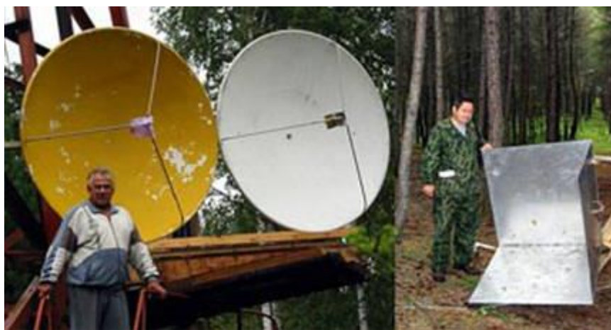
Рис. 1. Сверхширокополосный импульсный радиолокатор для зондирования лесного покрова и углового отражатель (справа)
