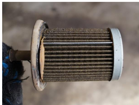
Рис. 1. Пример засоренного топливного фильтра
