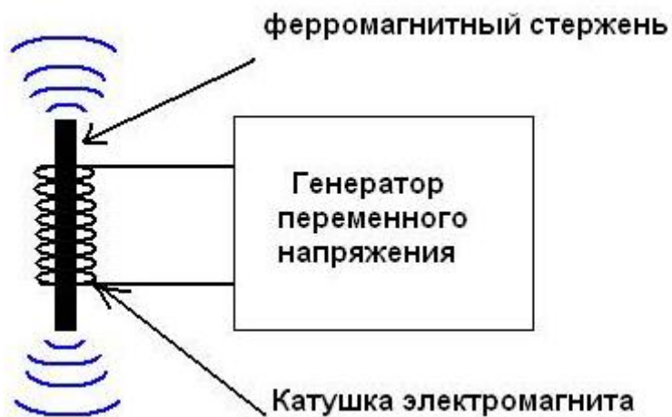
Рис. 3. Структурная схема ультразвукового излучателя
