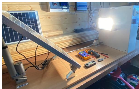
Рис. 1. Внешний вид лабораторного стенда «Исследование характеристик ФСМ»
