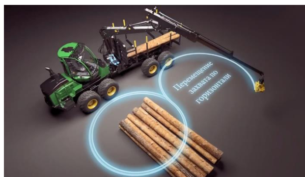
Рис. 2. Моделирование оптимальной траектории движения манипулятора
