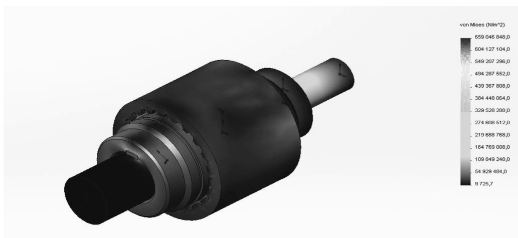
Рис. 4. Поля распределения напряжений в материале муфты
