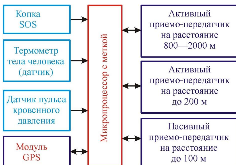
Рис. 1. Поисково-туристический радиодатчик (структурная схема)
