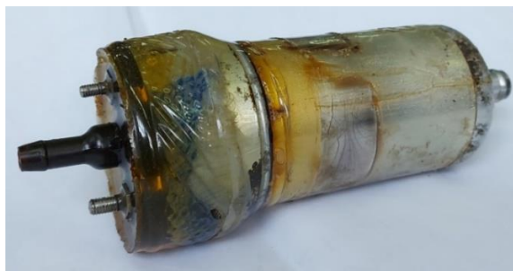
Рис. 2. Топливный насос после герметизации эпоксидной смолой
