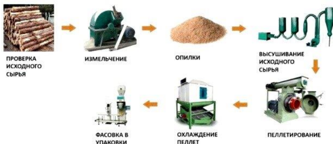
Рис. 3. Технологический процесс производства древесного наполнителя для кошачьих лотков
