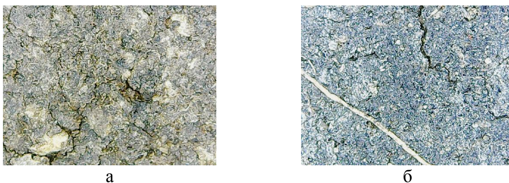
Рис. 3. Микрофотография (x40) образцов ПБС после экспозиции в грунте: а – скорлупа кокосового ореха; б – измельченный кокосовый субстрат
