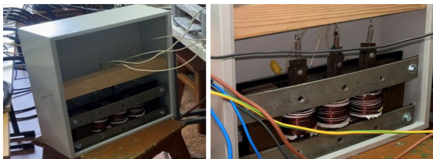
Рис. 3. Общий вид физической модели предлагаемого СУ с саморегулируемой индуктивностью Fig. 3. General view of the BD physical model proposed with self-regulating inductance
