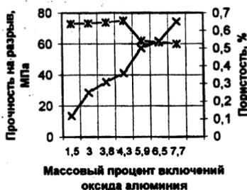
Рис.3. Зависимость предела прочности и пористости КМ от содержания в нем оксида алюминия
