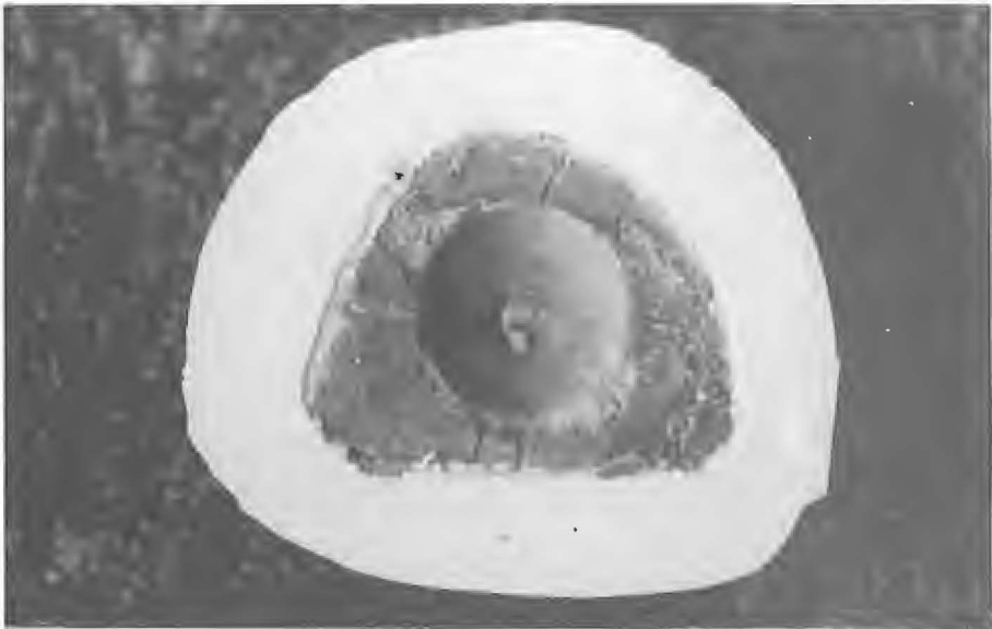
Figura 10.28. – Cilindro de revestimento com a fundição.
