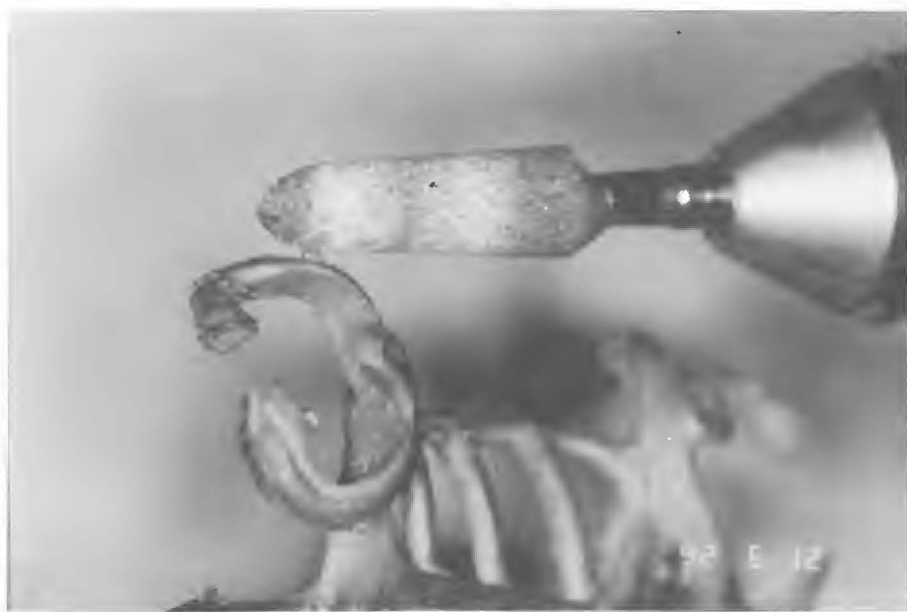
Figura 10.32. – Remoção de pontas agudas.
