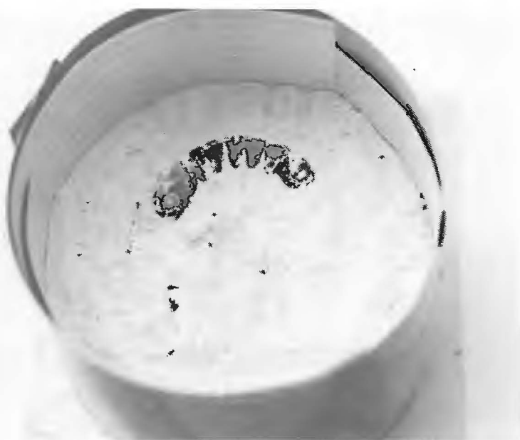
Figura 10.24. - Vazamento do revestimento.
