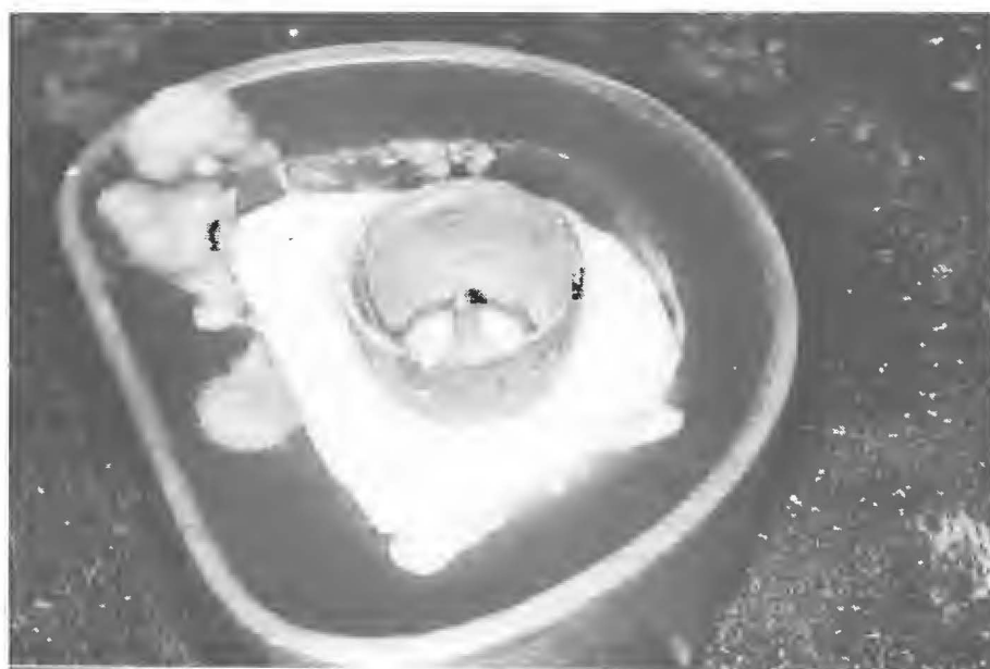
Figura 10.13. – Vazamento do modelo com revestimento.
