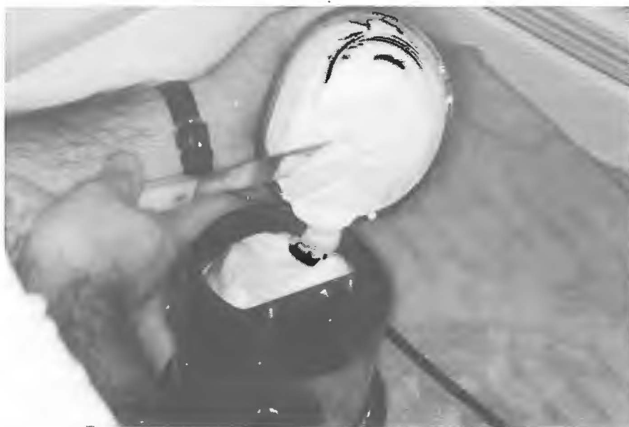
Figura 12.9. – Colocação do gesso sob vibração.
