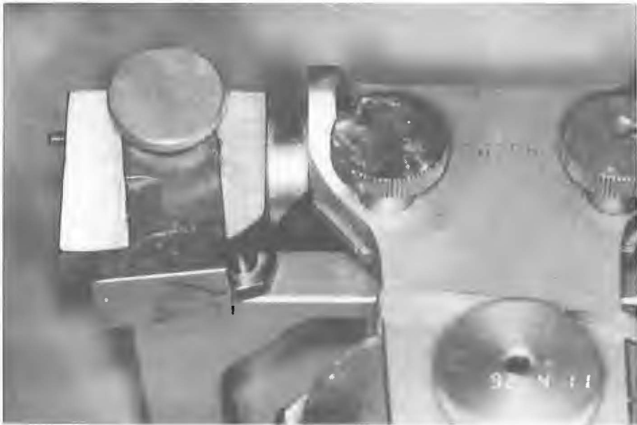
Figura 9.15. – Ajuste do ângulo de Bennet em 5°.
