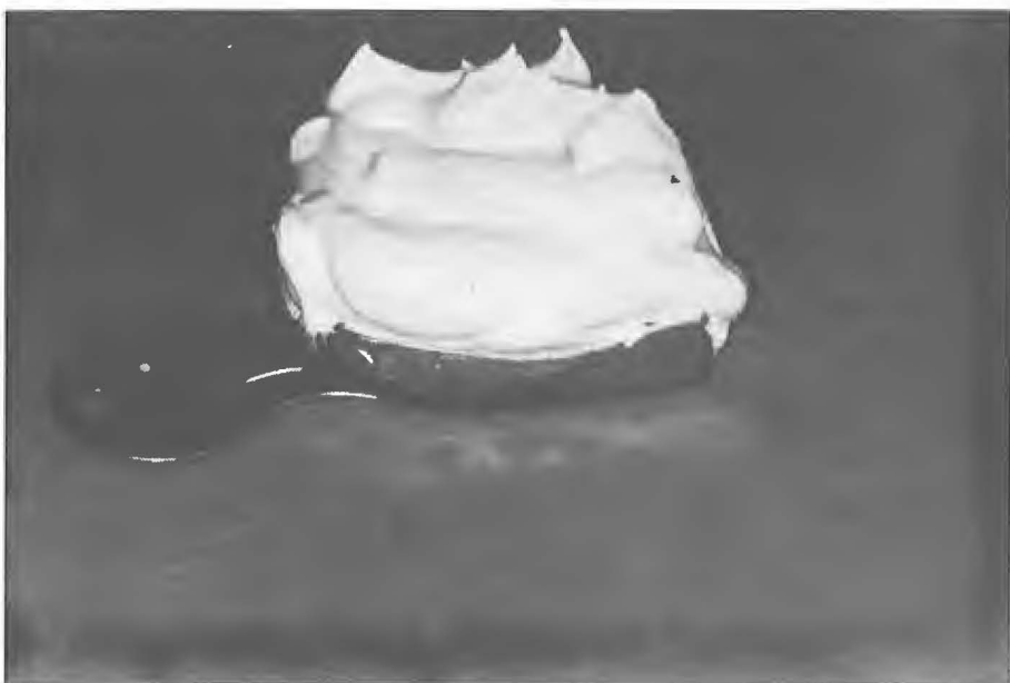
Figura 5.31. – Adição de porções maiores de gesso.
