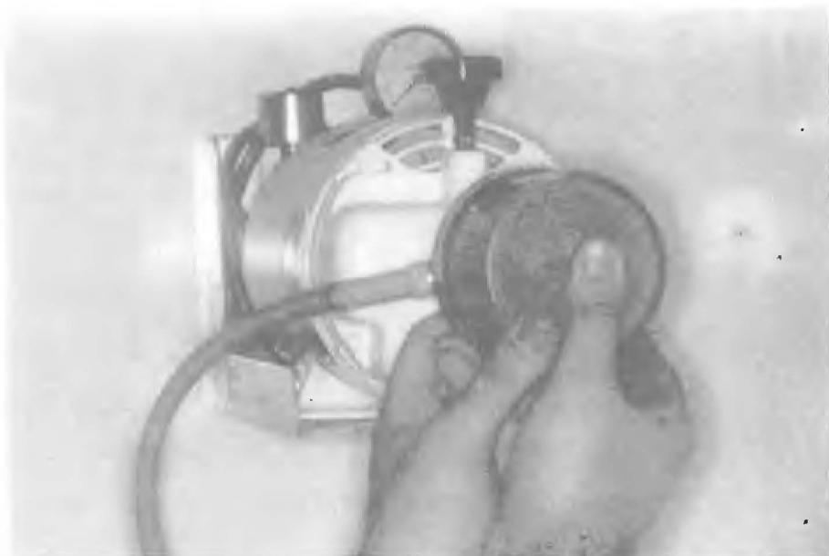
Figura 12.7. – Preparação do gesso no espatulador a vácuo.
