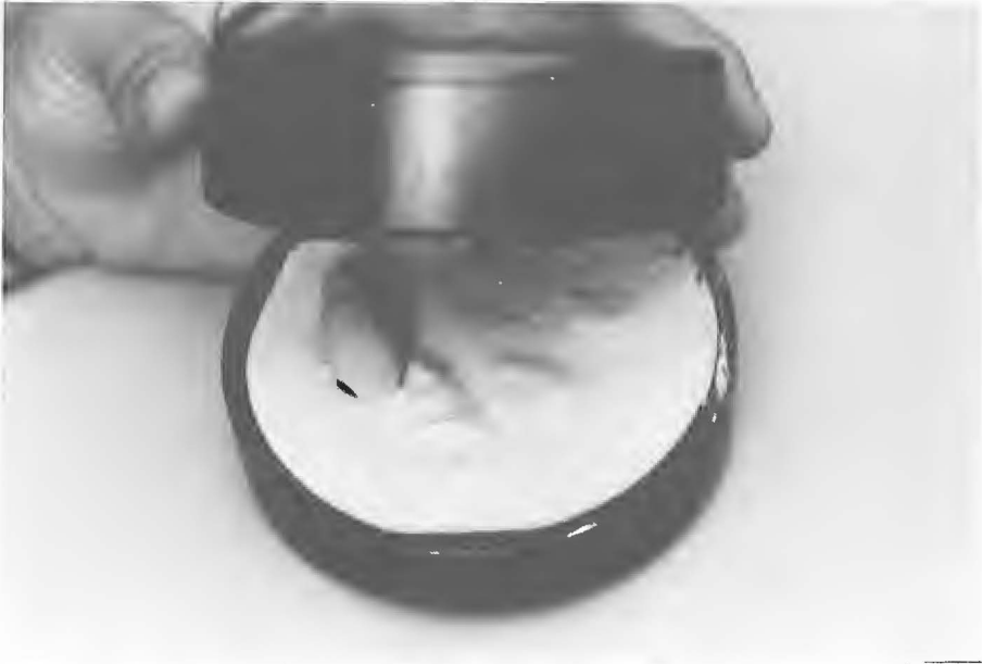
Figura 12.22. – A contramufla é então colocada de encontro à mufla.
