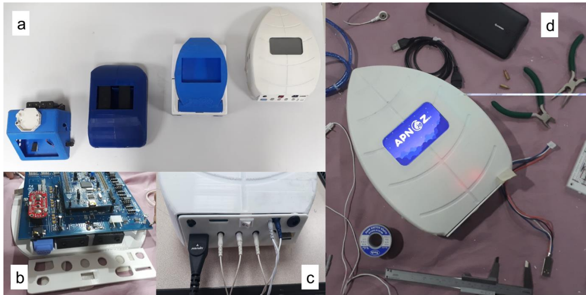
Figura 54. Encerramiento de polisomnógrafo. a) Evolución de encerramientos, b) Vista de elementos electrónicos al interior del encerramiento, c) Conexiones de sensores a dispositivo y d) Encerramiento final con pantalla touch encendida Fuente: autor
