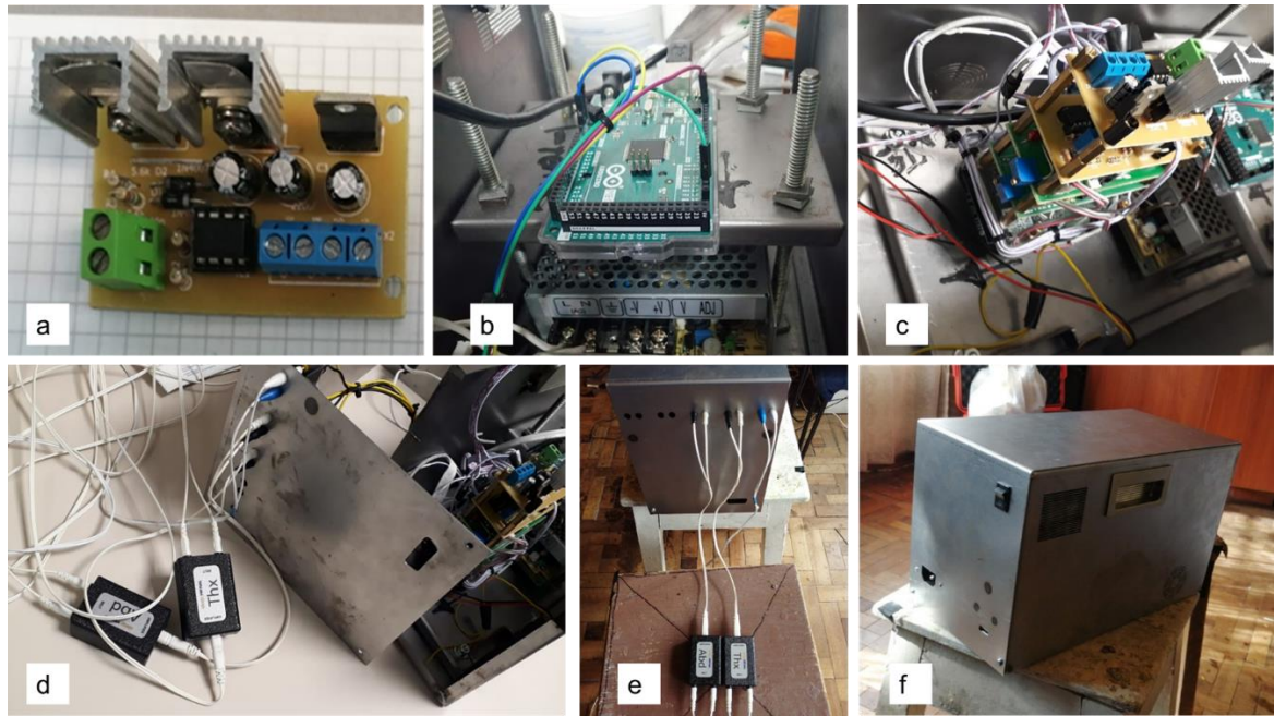
Figura 35. a. Fuente simétrica de tensión, b. Fuente regulada y tarjeta de procesamiento Arduino Mega, c. Implementación de circuitos en encerramiento, d. Entrada de sensores a encerramiento, e. Conexión de sensores de esfuerzo respiratorio a encerramiento y f. Encerramiento metálico primer prototipo.
