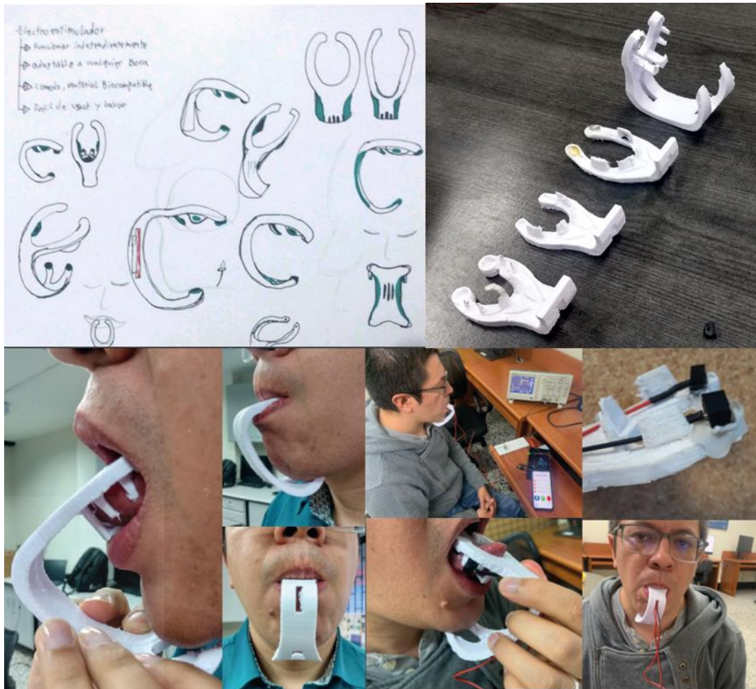
Figura 86. Diseño y validaciones pieza de electroestimulador donde se ubican los electrodos
