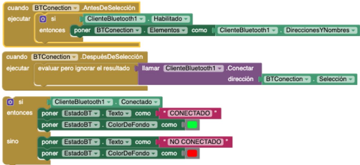
Figura 79. Programación conexión BT para aplicación móvil
