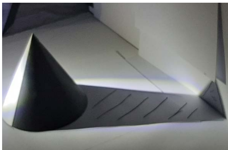
Figura 86 - Sombras de um cone, caso de sombra projetada com pontos de quebra. Fonte: própria.
