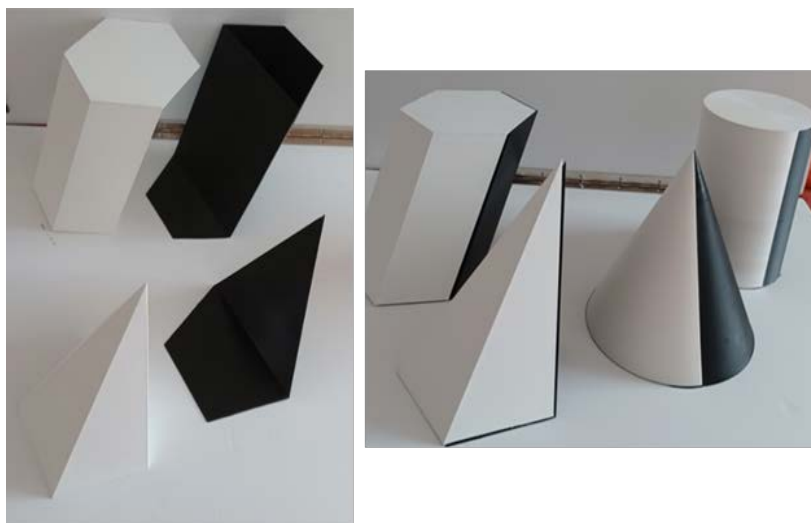
Figura 66 - Sólidos impressos em 3D, no FABLAB da FBA. Fonte: própria
