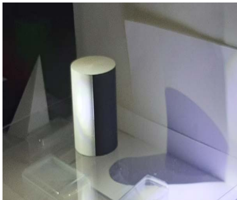
Figura 75 - Experiência no Laboratório: Sombra própria e projetada nos planos de projeção de um cilindro de bases horizontais. Fonte: própria.
