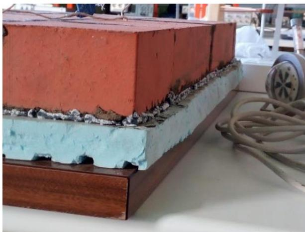
Figura 3.2: As várias camadas do pavimento com diferentes espessuras. Ao topo tijolo de burro (6 cm), ao centro poliestireno extrudido (3 cm), e na base um tampo de madeira (3 cm).
