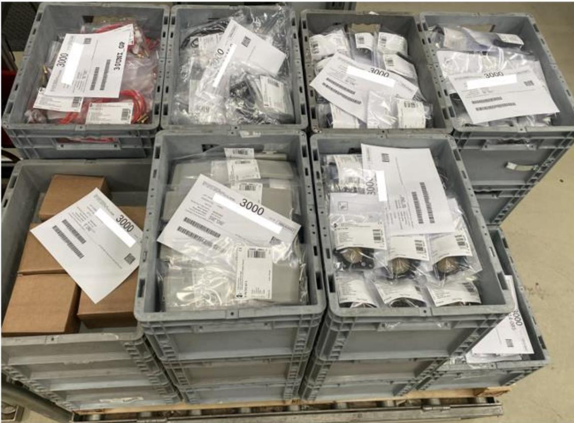
**Figura 23 - Conjunto de caixas retornáveis com peças de substituição colocadas em paleta**
