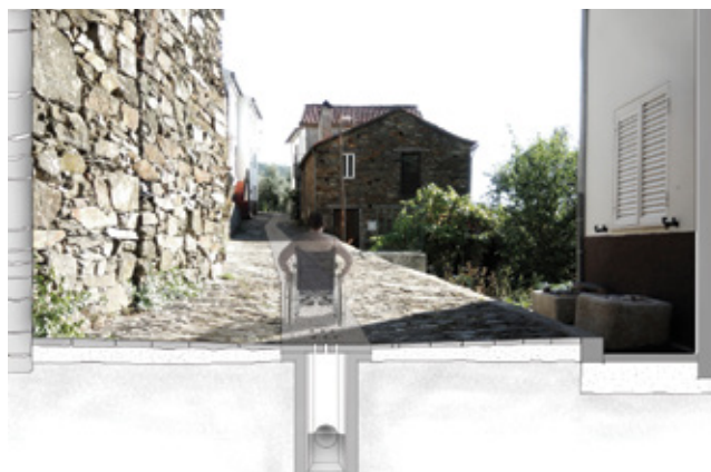
Figura 99 – Corredor central em lajetas de granito Fonte: o autor
