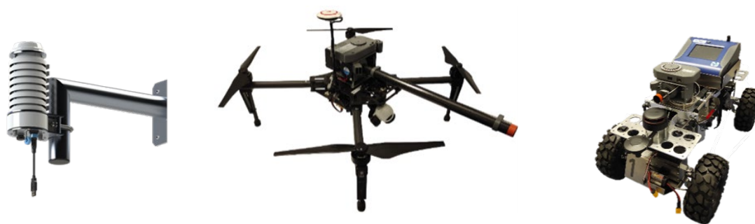
Kuva 2. Mittauksissa käytetyt kiinteä tiedonkeruuyksikkö sekä liikkuvat mittausyksiköt: drooni ja maarobotti.
