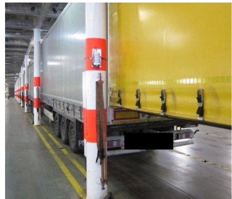
b. Pylvääseen kiinnitetty RASEM sensori.
