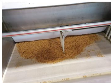
Figure 2.10 : Déshydratation des co-produits de pressage des graines de grenade avec un sécheur à tapis industriel en continu.
