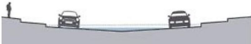
Figur 1. Skyfallsväg med lågpunkt i mitten på vägen. Vid stora vattenmängder fungerar vägen som ett dike och avleder vatten (Illustration: Ramboll, SMHI 2018).
