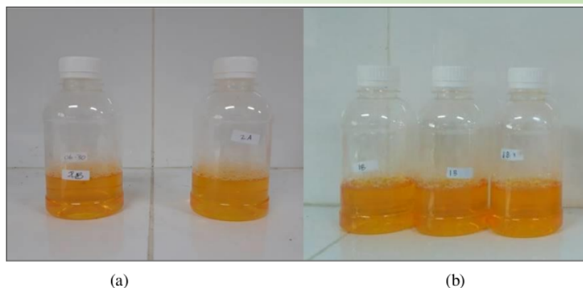
Gambar 3. Pengaruh waktu saponifikasi. (a) saponifikasi 12 jam, (b) saponifikasi 24 jam
