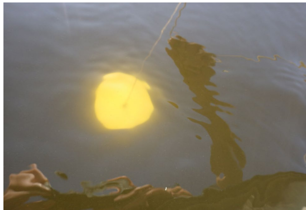
Figur 9. Med en vit skiva som sänks ner i vattnet kan siktdjupet bestämmas och därmed en bedömning göras hur långt ljuset når ner. Växtlighet kan som tumregel växa ner till det dubbla siktdjupet och därmed är det ner till det djupet som syrgasproduktion sker.
