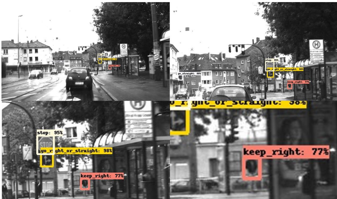
Abbildung 31: Fehler bei der Erkennung von Verkehrsschildern.
