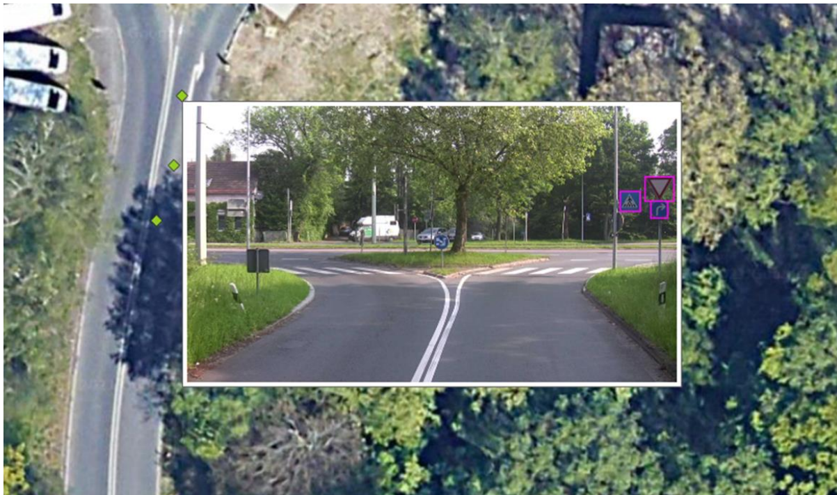
Abbildung 45: Beispiel für die Kennzeichnung detektierter Verkehrszeichen über KI
