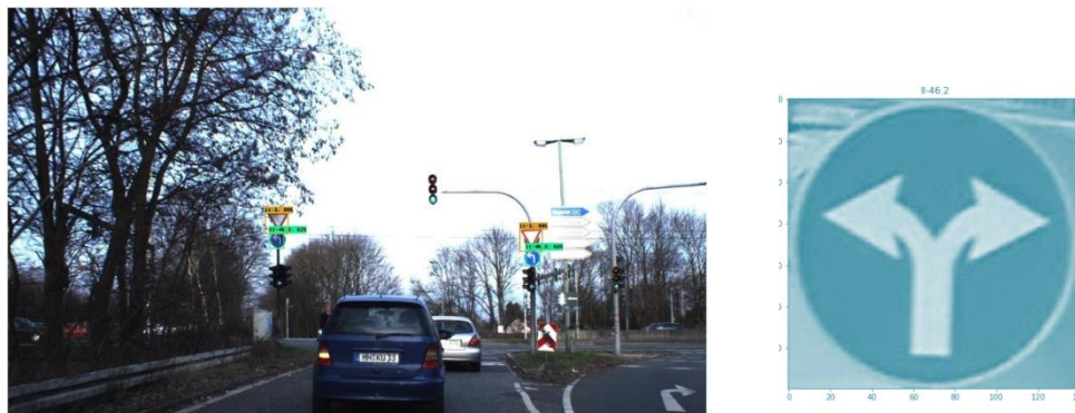
Abbildung 29: Erkennungsfehler wegen fehlender Klasse in den Trainingsdaten: Statt dem Linksabbiegegebot wurde ein Geradeausfahrverbot (DFGTS:II-46.2) erkannt
