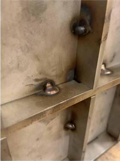
fig. 4A: Filler TIG Welds
