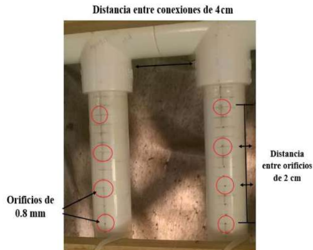
Figura 3. Dimensión de los orificios del sistema automático.
