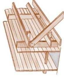
Formación de un encofrado de madera para la construcción de muro
