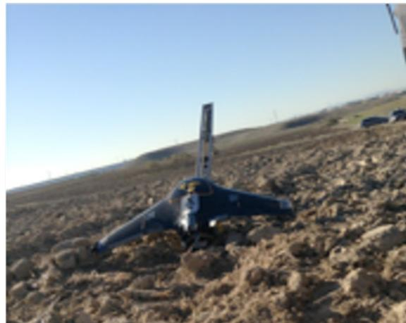
Vehículo aéreo no tripulado. UX-5 Trimble. (DRON)
