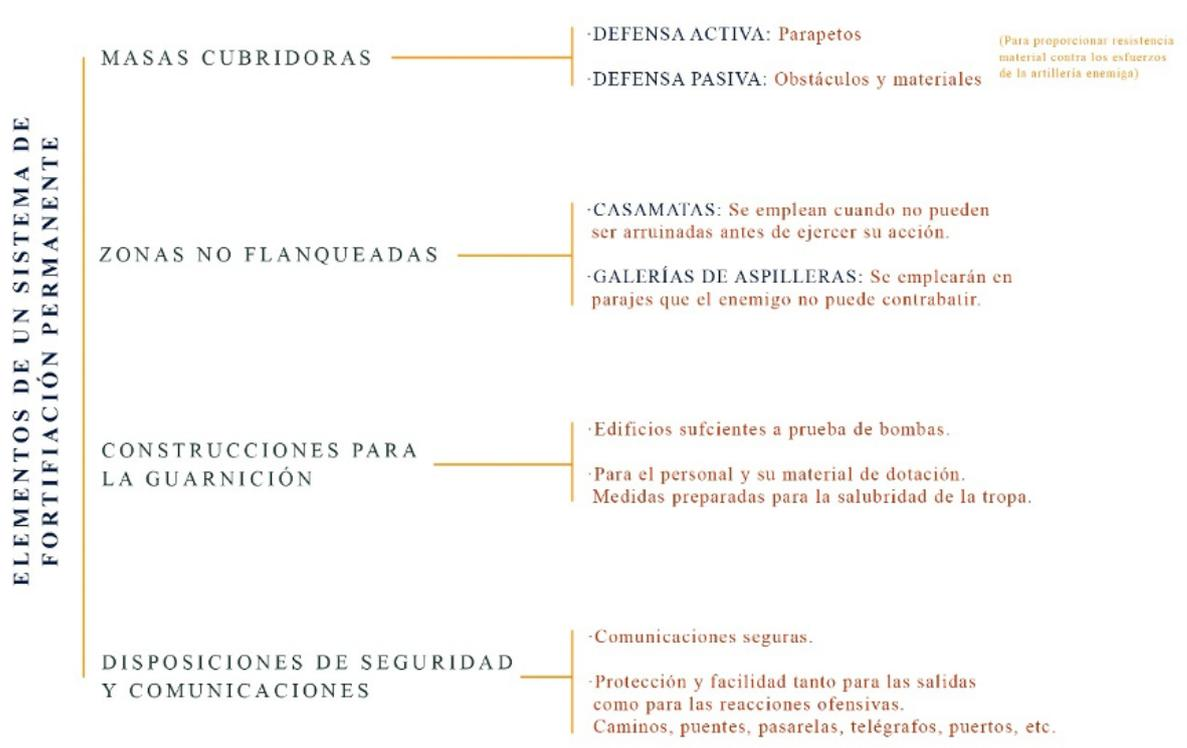
Tabla 8. Esquema de elementos de un sistema de fortificación permanente. Elaboración propia en base a García Herrera 1846
