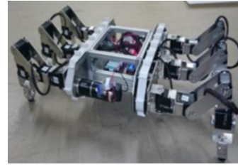
図1. 6脚クローラ型不整地移動ロボット
