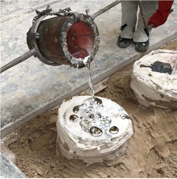
fig. 4.31 Pouring the aluminium
