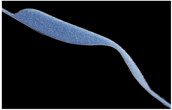
Figure 3 : Choc stationnaire en amont d'une topographie dans un écoulement granulaire. Le choc est créé par l'ajout de particules en amont de la topographie (d'après Viroulet et al. , 2017).
