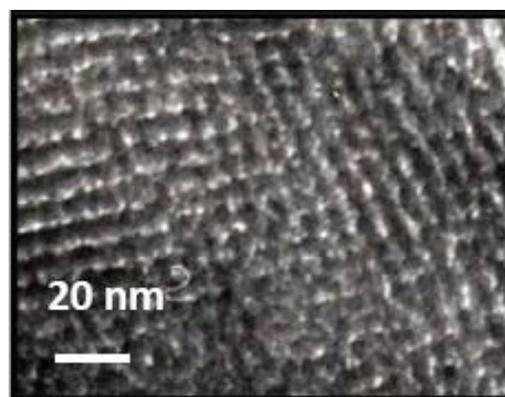
Figura 6. Imagen tomada por TEM de film mesoporoso de TiO<sub>2</sub>.
