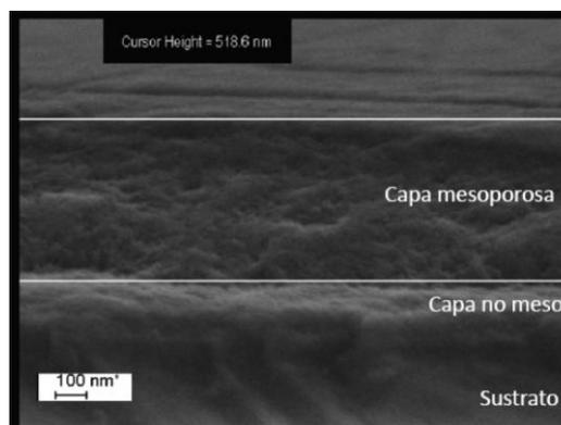
Figura 5. Imagen de SEM de perfil de film mesoporoso de TiO<sub>2</sub> de 5 capas
