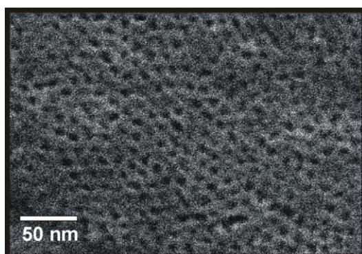
Figura 4. Imagen de SEM de la superficie de film mesoporoso de TiO<sub>2</sub> de 5 capas.
