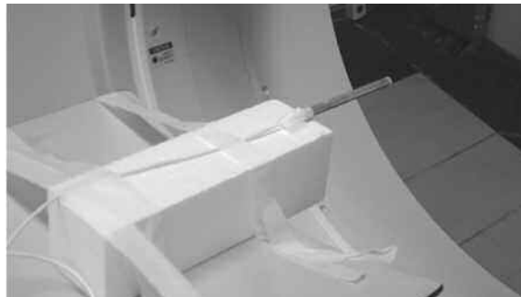
Fig. 4. Cámara de Ionización tipo lápiz ubicada para mediciones en aire.
