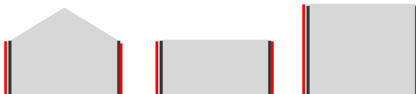
Slika 3.1 Shematski prikaz zunanjih sten proti neogrevanemu prostoru za posamezne arhitekturne tipologije stavb predšolske vzgoje ( a) pritlična stavba z dvokapno streho, b) pritlična stavba z ravno streho, c) dvonadstropna stavba z ravno streho)
