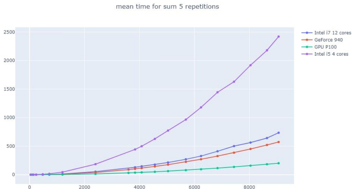
Рис. 4.31 – Додавання матриць із повторенням операції 5 разів всередині потоку
