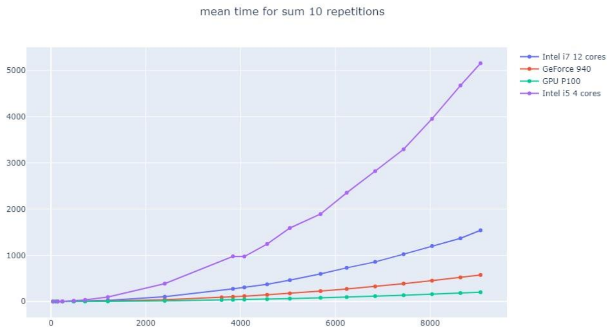
Рис. 4.34 – Додавання матриць із повторенням операції 10 разів всередині потоку
