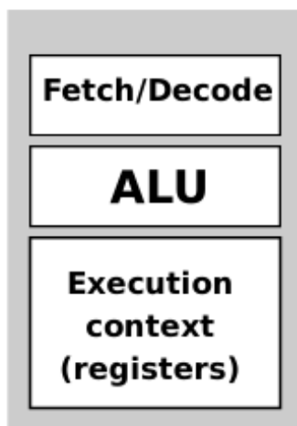
Рис. 1.8 – Схема спрощеного ядра центрального процесора [9]
