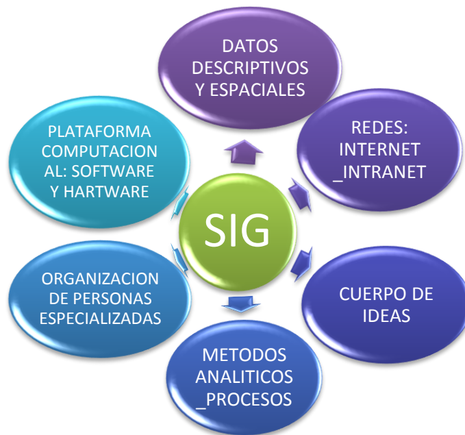
Figura 8: Componentes de un Sistema de Información Geográfica (SIG)
