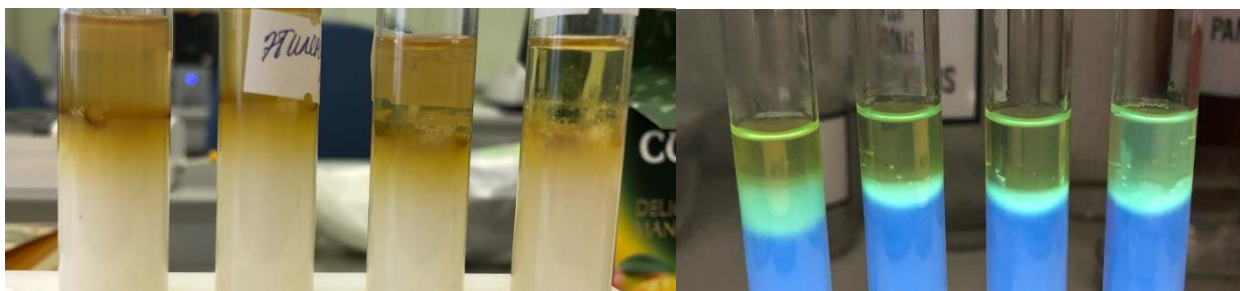
Рисунок 1. Модели желатиновых пластин с использованием в качестве индикаторов основного ацетата свинца и комплексов с алюминия хлоридом (последовательность извлечений на обоих экстрактах: ППГ, этиленгликоль, глицерин, ДМСО)
