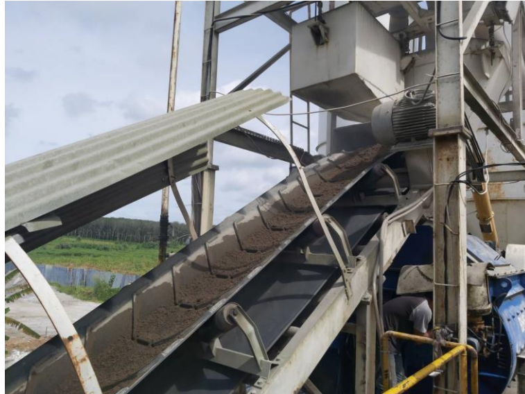
Gambar 2.4 Pengangkutan Material Menggunakan Belt Conveyor
