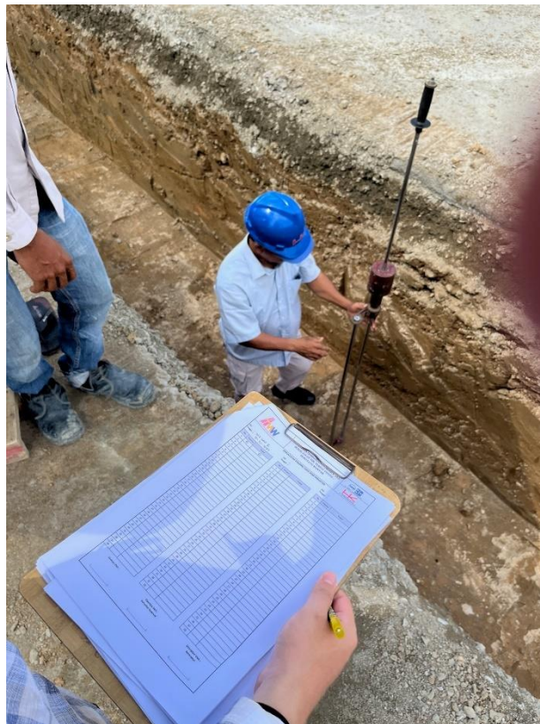
Gambar 2.12 Test DCP di lapangan pada titik change tanah
