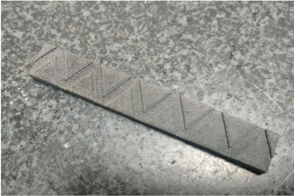
Figura 11. Pieza de patrón triangular SLS
