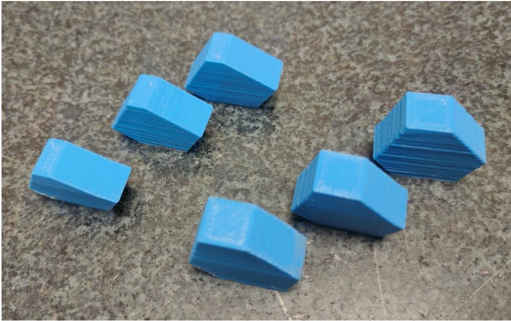
Figura 3. Piezas de 2 caras con distintos ángulos ( 30^\circ , 45^\circ , 60^\circ y 75^\circ ) y distintos espesores de capa (0,1 mm, 0,15 mm y 0,2 mm)
