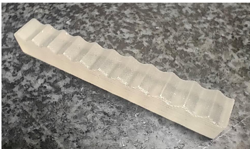
Figura 19. Pieza con forma senoidal y espesor de capa de 16 \mu\text{m}
