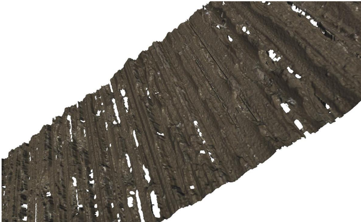
Figura 56. Detalle de la superficie de la pieza creada con Polyjet (60° y 192 \mu\text{m} )
