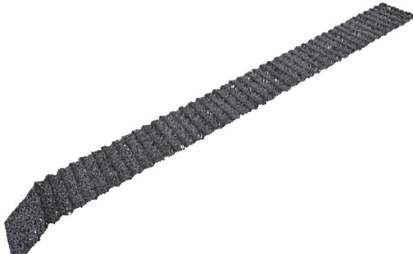
Figura 53. Superficie de 30° y 0,2 mm de espesor de capa tras la primera limpieza con aire a presión
