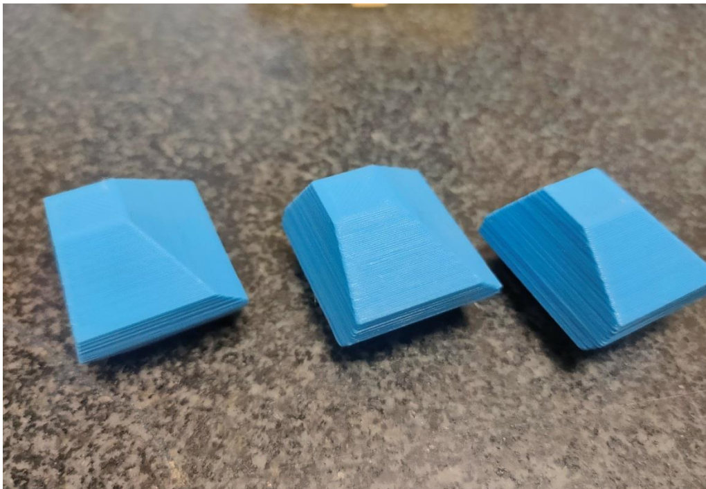
Figura 4. Piezas de 4 caras con distintos ángulos ( 30^\circ , 45^\circ , 60^\circ y 75^\circ ) y distintos espesores de capa (0,1 mm, 0,15 mm y 0,2 mm)
