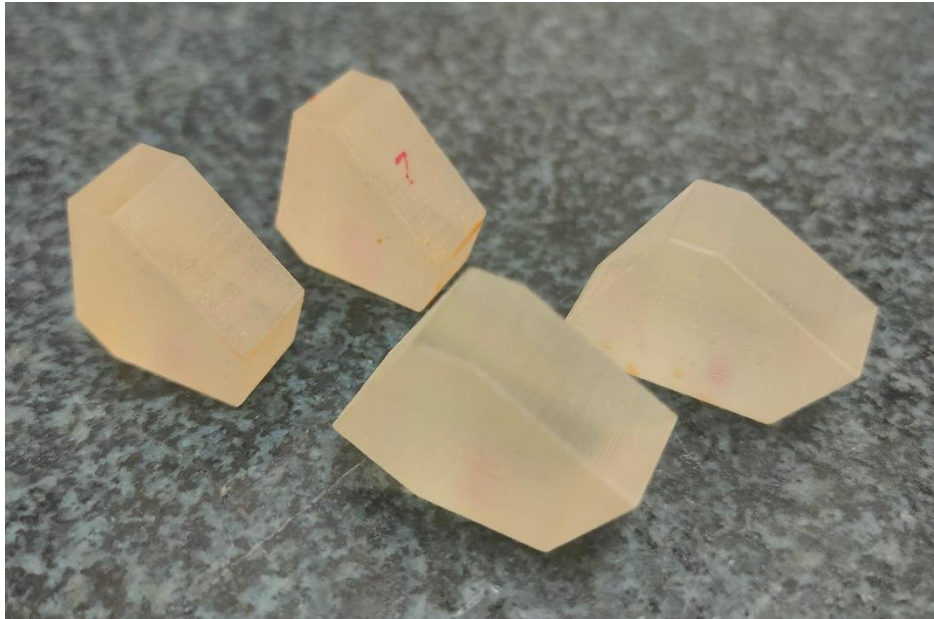
Figura 15. Piezas de 2 caras (30-60 y 45-75) diseñadas especialmente para espesor de capa de 96\ \mu\text{m} y 192\ \mu\text{m}
