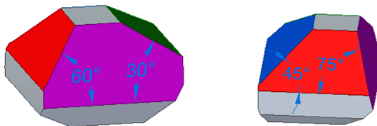
Figura 2. Ángulos de construcción de la pieza de 4 superficies
