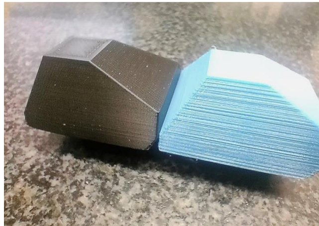
Figura 49. Comparación visual de pieza fabricada con Ultimaker y la fabricada con la impresora BQ
