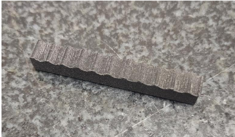
Figura 13. Pieza con forma senoidal SLS
