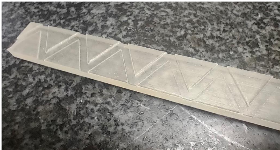
Figura 18: Pieza patrón triangular y espesor de 16 \mu\text{m}
