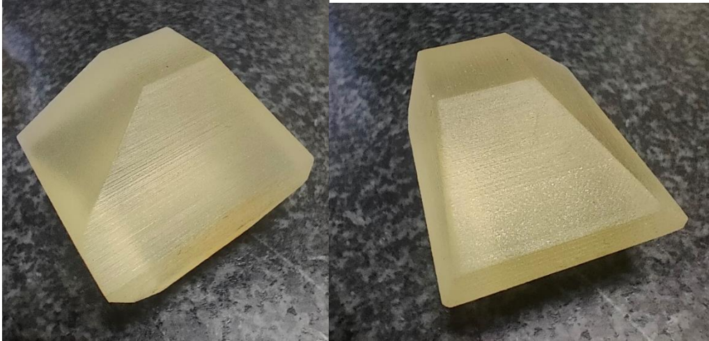
Figura 17. Pieza de 4 caras (30-45-60-75) con espesor de capa de 16 \mu\text{m}
