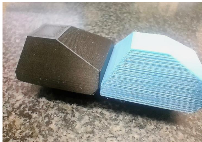
Figura 2. Comparación visual de pieza fabricada con Ultimaker y la fabricada con la impresora BQ
