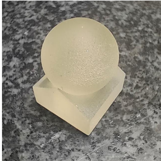
Figura 20. Pieza esférica y espesor de capa de 16 \mu\text{m}
