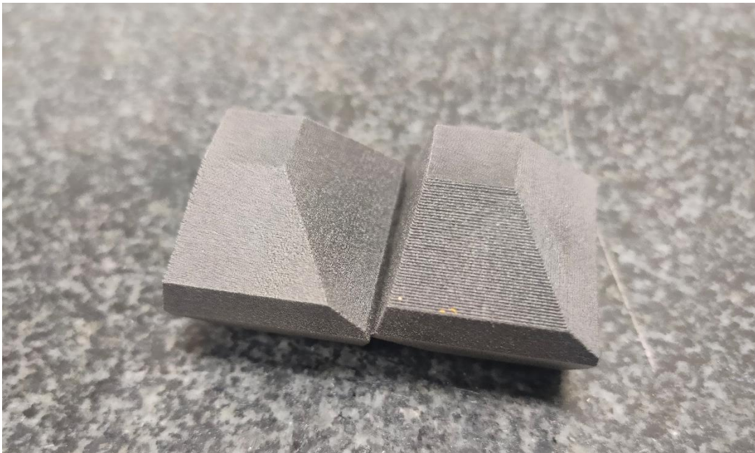
Figura 10. Piezas de 4 caras con distintos ángulos (30°, 45°, 60° y 75°) y espesores de capa (0,1 mm y 0,2 mm)
