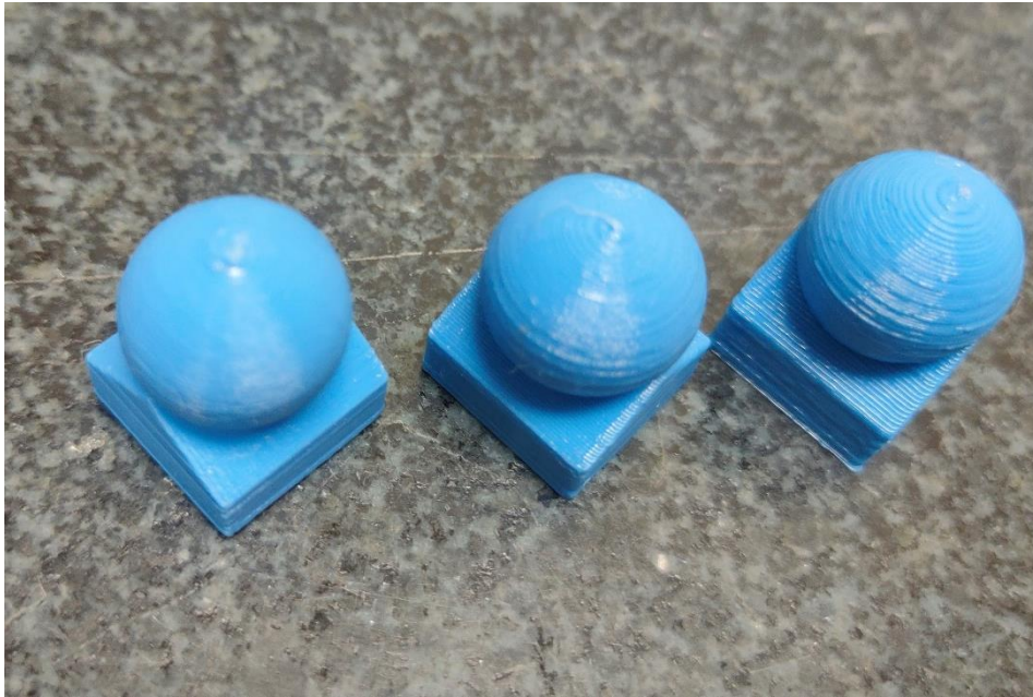
Figura 5. Piezas esféricas con distintos espesores de capa (0,1 mm, 0,15 mm y 0,2 mm, de izquierda a derecha)
