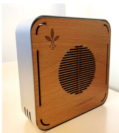
Figura 24. Monitor Inteligente de Calidad de Aire (MICA) utilizado en las mediciones. Elaboración propia.
