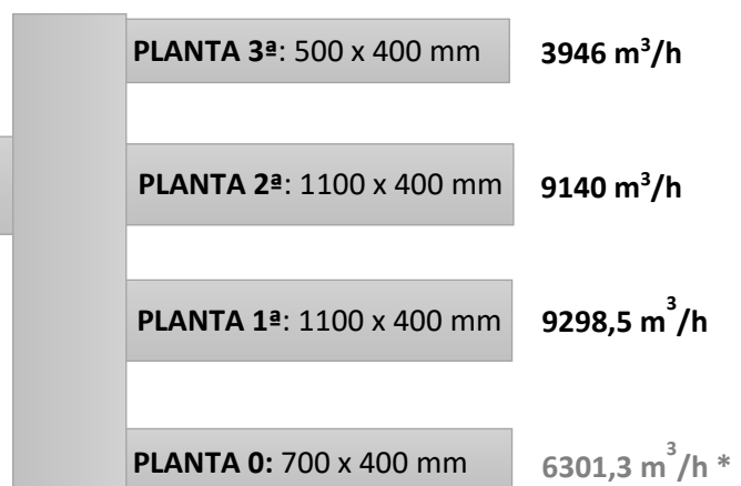
Figura 9. Dimensiones de los conductos y caudales de aire por plantas. Elaboración propia.
