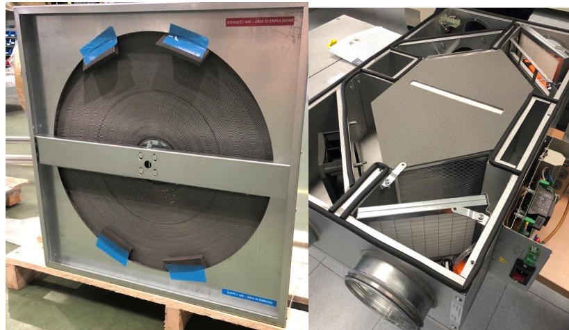
Figura 9. Recuperador rotativo (izda.) y de placas (dcha). Imagen propia, tomada en la visita a Evair.
