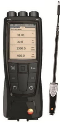
Figura 2. Testo 480 y sonda de molinete Fuente: [1]
