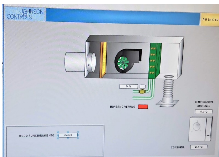
Figura 22. Representación del fancoil de una aula.
